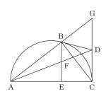
命題 3 CA が円の切片であるとして,B がその上の任意の点,BD が AC の上の垂線であるとし,切片 DE が DA に等しく,弧 BF が弧 BA に等しいとすると,確かに,結ばれた CF は CE に等しいであろう。
