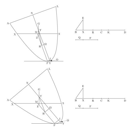
定理9 直角円錐状体の [任意の] まっすぐな部分 [切片] が, [その焦点を通るように,] その軸まで [垂直に引かれた直線] の1倍半より大きい軸を持ち,さらに,それ [軸] が [その軸までの直線に対して,] 15 が4に対して持つ [比] より小さい比を持ち,そして,重さに関して,それが [それと同じ大きさの] 液体に対して,その軸による正方形が,その軸がその軸までのそれ [直線] の1倍半より大きい超過分による正方形より大きい,超過分がその軸による正方形に対して持つ [比] より大きい比を持つとき,それ自身の底面全体が液体の中にあるように沈められ,傾けられて置かれたとすると,その軸が液体の表面に対して前と同様に受け入れられた [角] に等しい角をつくらない限り,その軸が垂直になる [ように立て直される] こともなく,傾いたままに留まることもないであろう。
