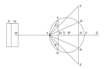
命題 10 球状体のすべての切片の重心は、その (球状体の) 切片の軸である線分上にあり、かつ、この線分を、(球状体の) 切片の頂点に近い方の部分が、残りの部分に対して、(球状体の) 切片の軸と、(球状体の切りとられた切片と) 反対側の切片の軸の 4 倍との和が、(球状体の) 切片の軸と、反対側の切片の中に含まれる軸の 2 倍との和に対するのと同じ比をもつように分割する点である。
