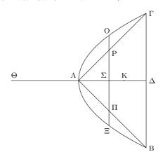
命題 6 すべての半球の重心は、その (半球の) 軸である線分上にあり、かつ、この線分を、半球の表面に近い方の部分が、残りの部分に対して、5 が 3 に対するのと同じ比をもつように分割する点である。
