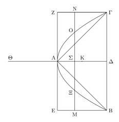
命題 5 軸に垂直な平面によって切りとられた直角円錐状体の切片の重心は、この切片の軸である線分上にあり、かつ、この線分を、(直角円錐状体の) 頂点に近い方の部分が、残りの部分の 2 倍になるように分割する点である。
