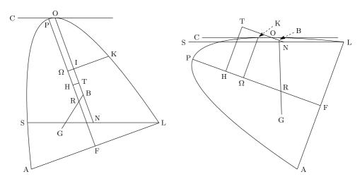
定理 8 直角円錐状体の [任意の] まっすぐな部分 [切片] が, [その焦点を通るように,] その軸まで [垂直に引かれた直線] の1倍半より大きい軸を持ち, さらに, それ [軸] がその軸までのそれ [直線] に対して, 15 が4に対して持つ [比] より小さい比を持つとき, もしその重さが [それと等しい大きさの] 液体に対して, その軸がその軸までの1倍半より大きい超過分による正方形が, 軸による正方形に対して持つ [比] より小さい比を持つならば, それ自身の底面が液体に接しないようにその液体の中に沈められたとすると, その軸が液体の表面に対して, [以下で] 述べられるであろう, それ [角] に等しい角をつくらない限り, まっすぐに立て直されることもなく, 傾いたままに留まることもないであろう。
