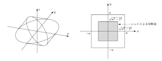
上左図のような立方体について,上右図のように座標軸を設定し,立方体の 1 辺の長さを a とする。すると,平面 z=t による切断面は 1 辺の長さが  $2\sqrt{a^2-t^2}$  の正方形となるから,この正方形の面積は  $S(t)=4\left(a^2-t^2\right)$  となる。したがって,問題の立体(交差した円柱)の体積 V は
