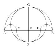
命題 15 もし半円 AB があったとして,AC が五角形の [1 辺である] 弦で,弧 AC の半分が AD であるとし,CD が結ばれるとし,それが E の上に落ちるように延長されるとし,F において AC を切断する DB が結ばれるとし,F から AB の上に垂直な FG が引かれるとするならば,直線 EG は円の半径に等しいであろう。
