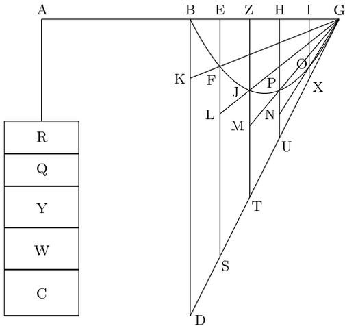
なぜならば。直線 ABG が引かれ、そして、直線 BG に等しい AB が切り取られるとし、私たちは、AG が、その中点が点 B であり、B で吊るされる、天秤であると想像しよう。さらにまた、BDG が天秤に点 B, G から吊るされ、天秤の他方の側には点 A から広がり R, Q, Y, W, C が吊るされるとしよう。そのようになっている、広がり R と台形 DE が、さらに、Q と台形 ZS が、さらに、Y と台形 TH が、さらに、W と台形 UI が、そして、C と三角形 XIG が、互いにもっている釣り合いを保つものとしよう。それゆえ、全体
