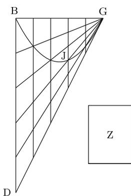
「再び、 $BJG$  が直線および直角円錐切断 [放物線] によって囲まれた切片であるとし、そして、 $B$  を通って直径に平行な  $BD$ 、および  $G$  から点  $G$  において円錐切断に接する直線  $GD$  が引かれるとしよう。そして、広がり  $Z$  が三角形  $BDG$  の 3 分の 1 であるとする。それゆえ、私は、切片  $BJG$  は広がり  $Z$  に等しい、と言う。」(証明略)
