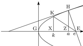
左図のように座標軸を設定し、放物線を表す方程式を  $y^2 = 4px$  とすると、先に見たように、点  $H$  での接線の傾きは  $\sqrt{\frac{p}{a}}$  となるから、点  $H$  における法線の方程式は
