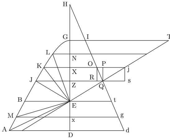
「もし双曲線の軸の上に、切断線〔双曲線〕の頂点から直立辺の半分より大きく離れている、点〔E〕がとられるとし、そして、与えられた点〔E〕および切断線の中心〔H〕の間に切り取られるもの〔HE〕が、中心に隣接するその部分〔HZ〕が横断する直径に対応するように、それらの切片に関して横断する直径が直立辺に対して互いにもっている比に分割されるとし、そして、分割点〔Z〕から切断線に出会うまで軸に垂直な線が立てられるとするならば、その交点〔J〕および軸の上に
