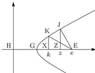
左図のように座標軸を設定し、双曲線を表す方程式を  $\frac{x^2}{a^2} - \frac{y^2}{b^2} = 1$  とすると、点 J(z, j) における接線の傾きは  $\frac{b^2 z}{a^2 j}$  であるから、点 J における法線の方程式は  $y = -\frac{a^2 j}{b^2 z}(x - z) + j = -\frac{a^2 j}{b^2 z}x + \frac{a^2 + b^2}{b^2}j$  となる。
