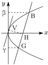
左図において、放物線  $BVG$  と直線  $BG$  によって囲まれた切片について、直線 [線分]  $BG$  がこの切片の底線であり、放物線上の点からこの底線への垂線のうち長さが最大の  $VH$  がこの切片の高さであり、このときの放物線上の点  $V$  がこの切片の頂点である。なお、この点  $V$  は直線  $BG$  に平行な直線が放物線と接する点といってもよい。
