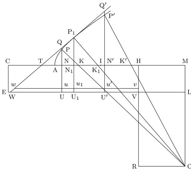
左図で、 $APP_1P'$  は  $A$  を頂点とする双曲線とし、 $C$  をその中心とする。 $AM$  が直立辺の長さ  $l$  の半分より大きくなるように点  $M$  を軸上にとる。 $A$  に対置するもう1つの頂点を  $A'$  とするとき、まず、 $CH : HM = AA' : l$  となるように点  $H$  を定める。次に、 $CA$  と  $CH$  の間に2つの比例中項  $CN_1, CI$  をとる。さらに、 $M$  における垂線  $MO$  の上に  $OL : LM = AA' : l$  となるような点  $L$  を定める。また、 $N_1$  における垂線と双曲線との交点を  $P_1$  とする。このとき、
