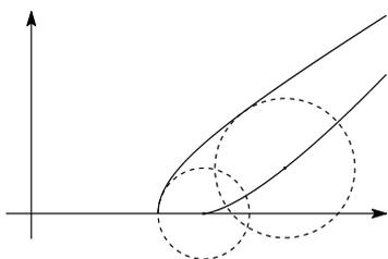
例えば、双曲線を表す方程式が  $\frac{x^2}{25} - \frac{y^2}{9} = 1$  のときは、 $a = 5$ 、 $b = 3$  ということだから、縮閉線を表す方程式は  $(5x)^{\frac{2}{3}} - (3y)^{\frac{2}{3}} = 34^{\frac{2}{3}}$  となる。これら 2 曲線を図示すると左図のようになる。ここに破線で表した円は曲率円 (の例) である。なお、この双曲線の頂点  $(5, 0)$  における曲率中心は  $(\frac{34}{5}, 0)$  であることが分かる。
